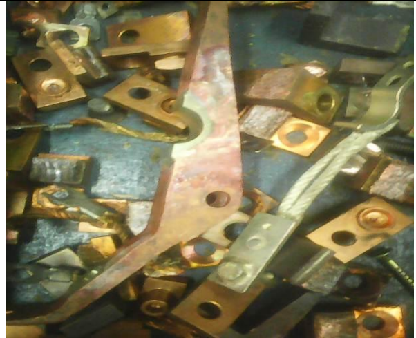
Figura 10. Contactos fijos, móviles y trenzas de cobre
