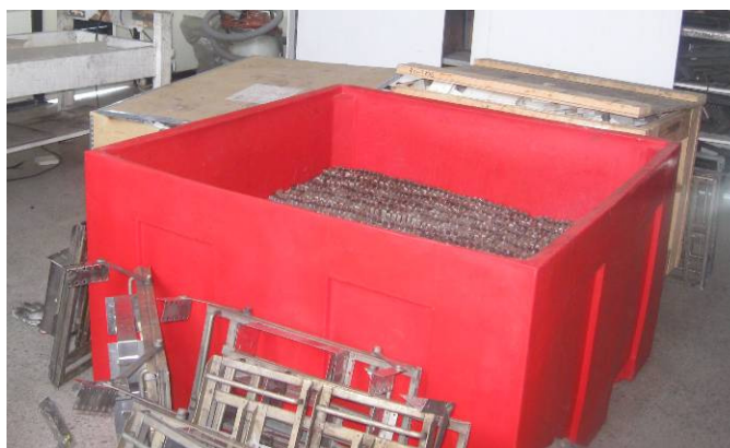
Figura 35. Bin estanco para almacenamiento de baterías de níquel cadmio
