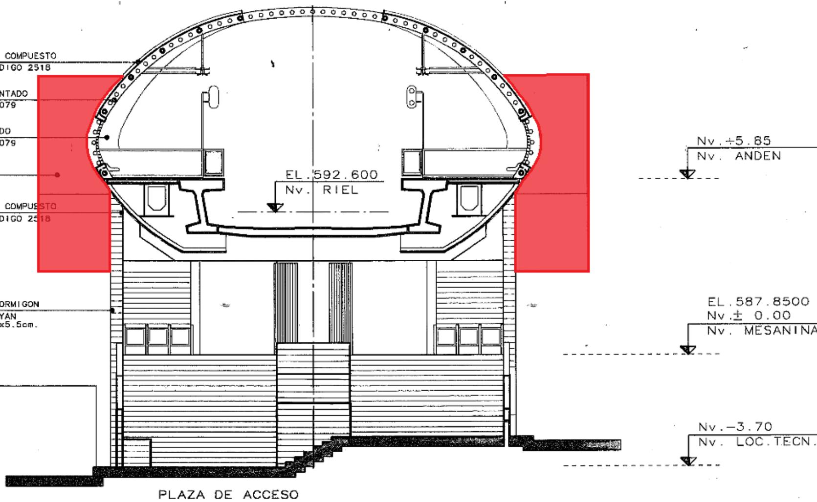
Se debe asegurar la estanquidad de la unión entre la cubierta de hormigón y el revestimiento metálico.
