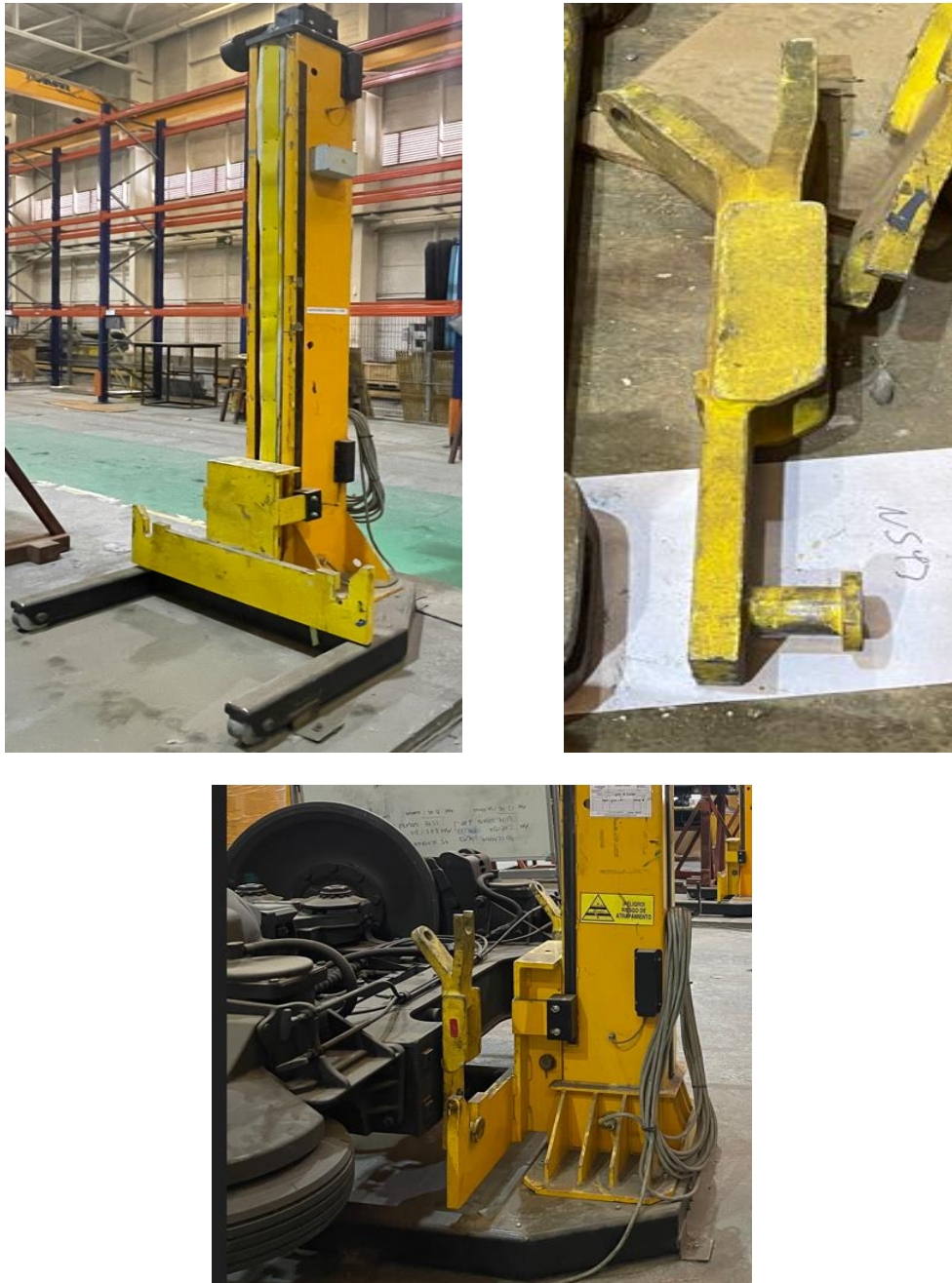
Figura 1. Columna elevadora de bogie y utillaje. (referencial)
