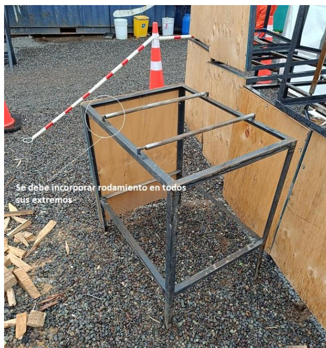
Ilustración 7: Harneros con rodamientos.
