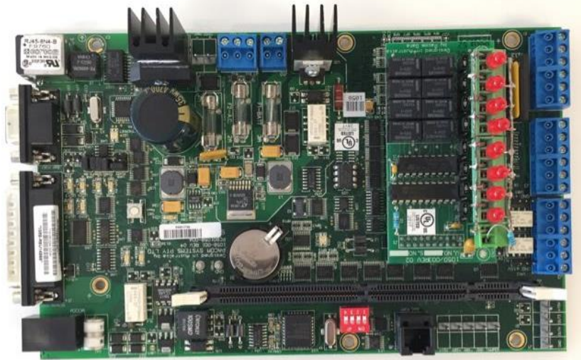
Figura 3. Vista referencial de tarjeta central de RTU PACOM 1058
