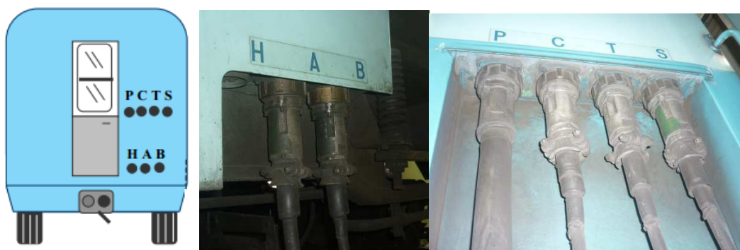
Figura 5. Imagen de acopladores, junto a un dibujo mostrando su ubicación en los coches.
