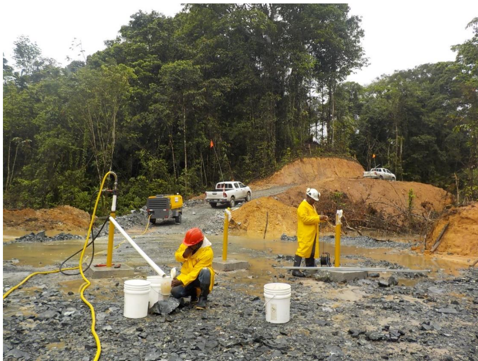
Figura 3 Realización de airlift en terreno
