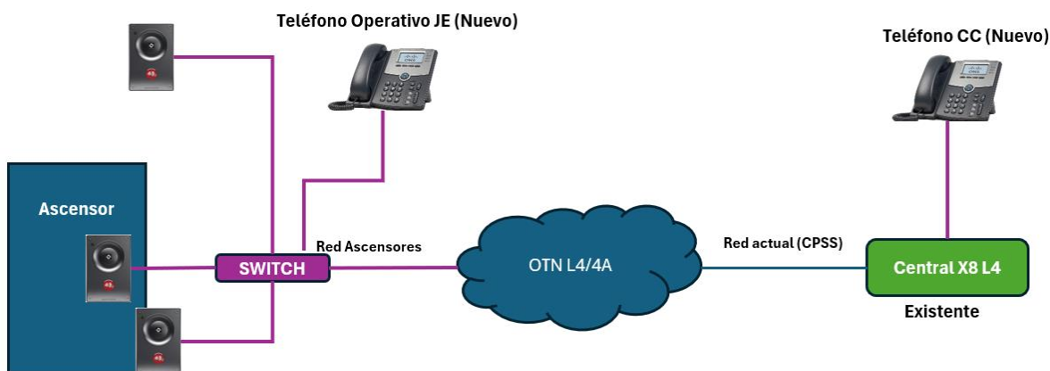
Figura 7: Imagen referencial de la configuración del sistema de telefonía
