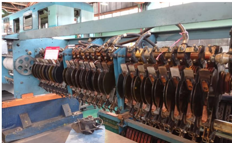
Figura 2 Contactores de Alta tensión
