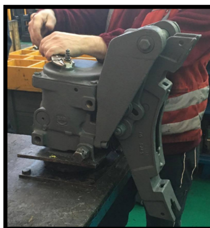
Figura 1: Block de Frenos BFC.
